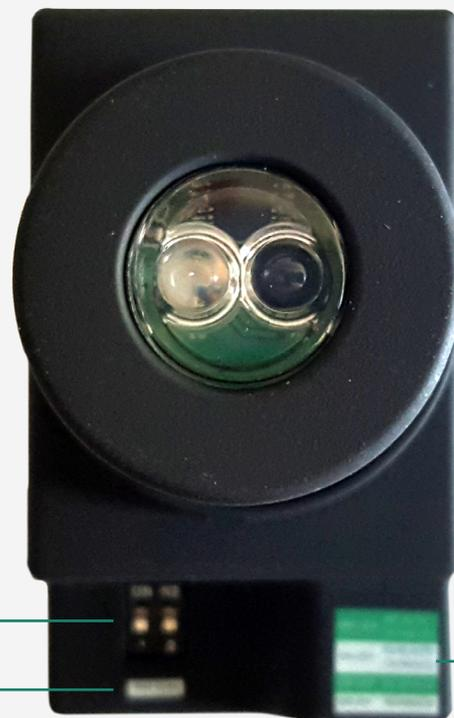
**5 Presa di Ricarica:** Usando l'input micro-USB del dispositivo, potete ricaricare la sonda ottica con qualsiasi dispositivo ricarica cellulare micro USB oppure tramite il cavo dato insieme alla sonda ottica.
